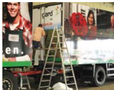
In Handarbeit werden vor Ort die Folien wie bei einem Großflächenplakat in Bahnen auf die LKW-Plane geklebt.
