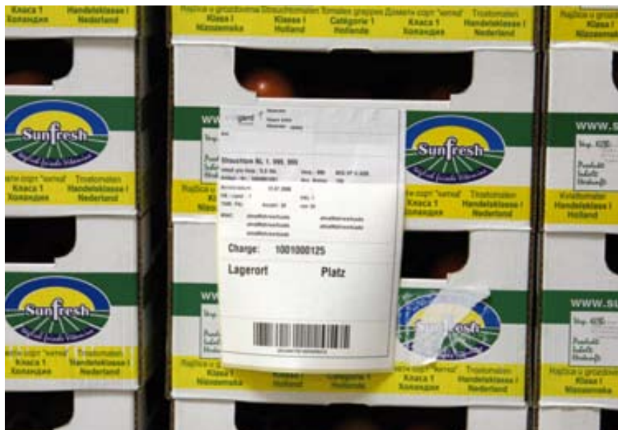
Das Wareneingangsetikett befindet sich an der Ware und ist mit einem Barcode versehen. Dieser wird beim Kommissionieren eingescannt und der Wareneingang im Scanner erfasst.
